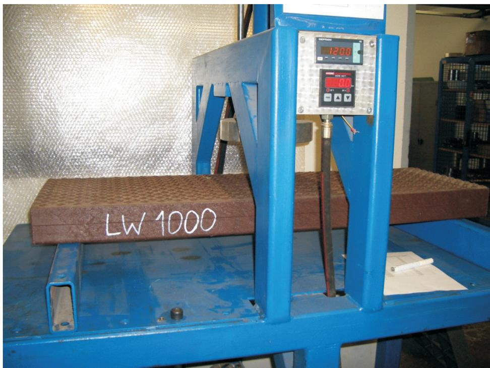
**Prüfkörper:** Kabelkanalabdeckplatte 1200x400x80mm
